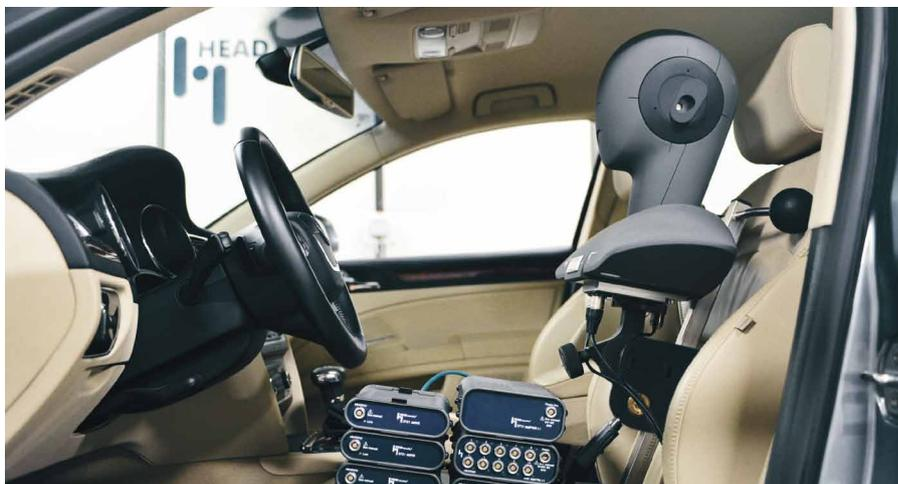
La HMS IV.0 peut se connecter directement sur le module de contrôle labCTRL I.1 d'un système HEADlab. Le support de siège HSM V permet d'embarquer facilement l'ensemble de matériel et le fixer de manière sûre en véhicule.
