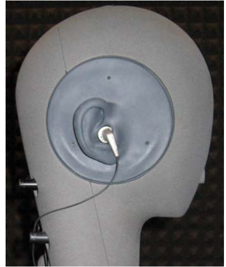
Headset-Tests mit EN 50332 und HMS II.3
