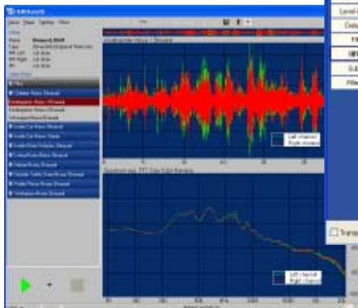
Binaurale Hintergrundgeräusch-Simulation mit HAE-BGN
