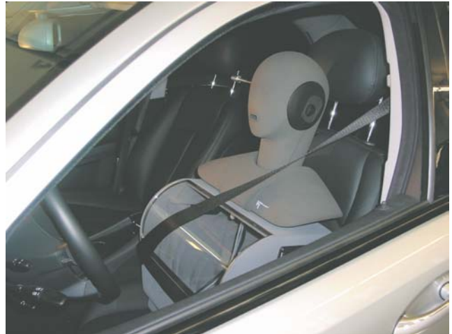
Kunstkopfmesssystem HMS II.3 im Einsatz bei der Analyse von Kfz-Freisprecheinrichtungen gemäß VDA-Spezifikation
