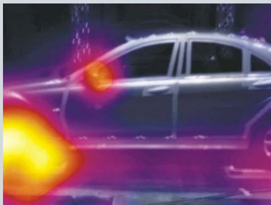
Windkanalkorrektur: Kompensation des Strömungsversatzes
