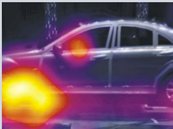
Versatz der Schallquellenanzeige im Windkanal
