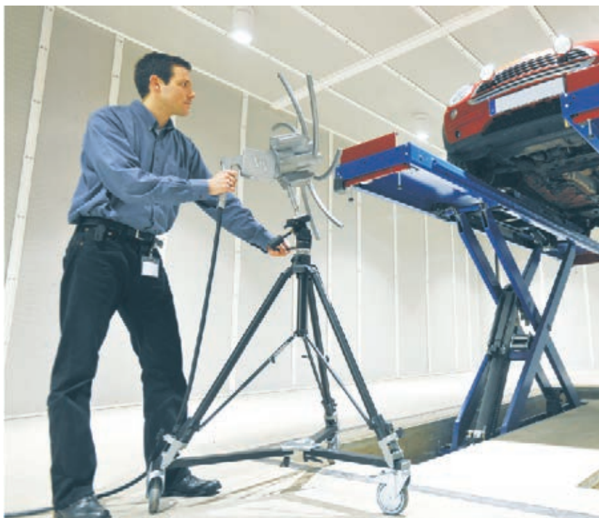
Bild 8: Einsatz im Gesamtfahrzeugprüfstand
